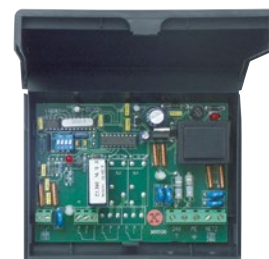
Корпус декодера Для кодкових замків CTR 1b-1, CTR 3b-1, CTV 3-1, CTR 3
